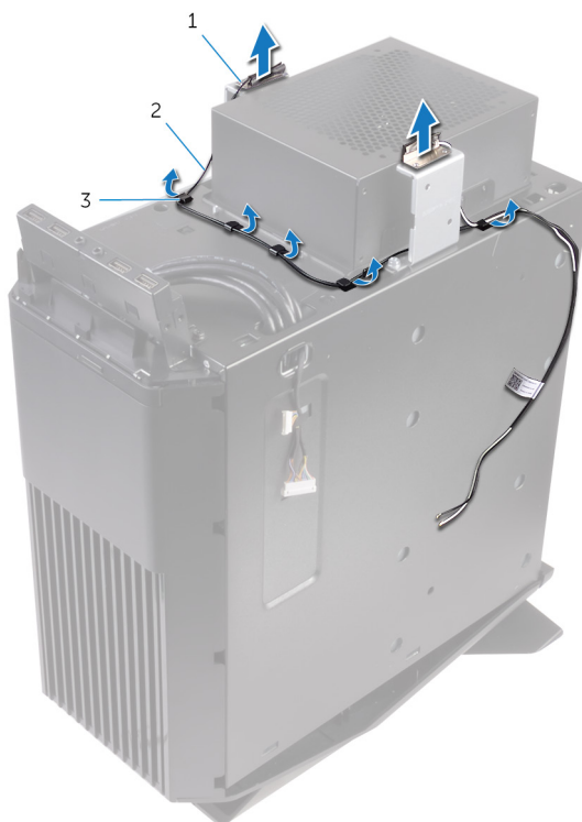
Figur 36. Fjernelse af antennekablerne
